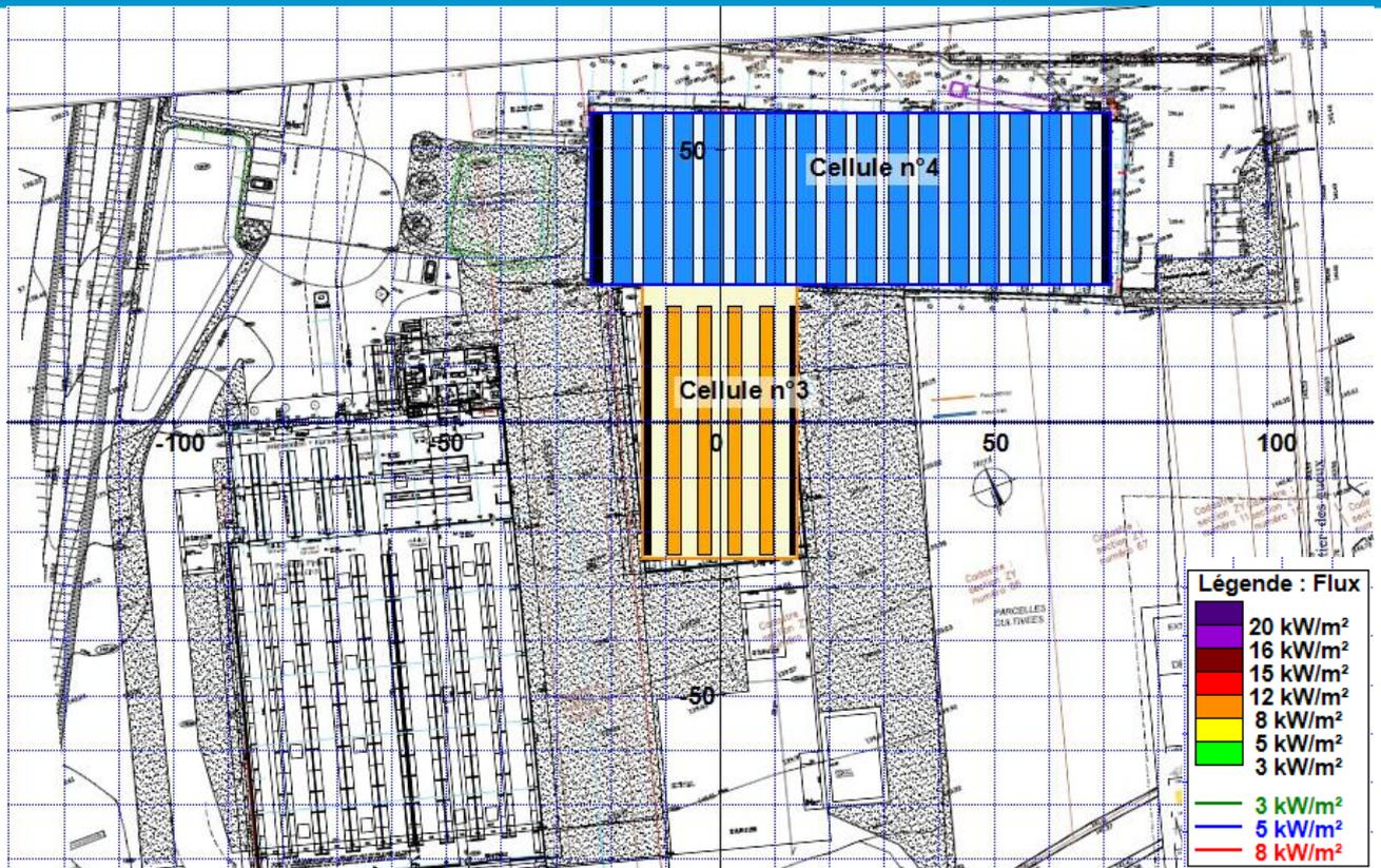
**FIGURE 11** : Effets des flux thermiques en cas d'incendie généralisé dans les Cellules 3 et 4
